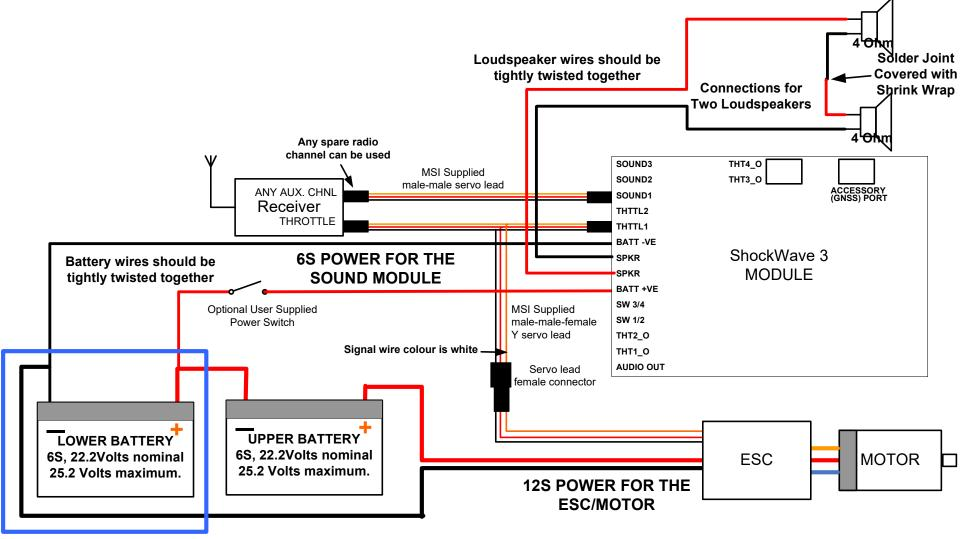
YOU MUST USE THIS LOWER BATTERY TO POWER THE SOUND MODULE, NEVER THE UPPER ONE!
